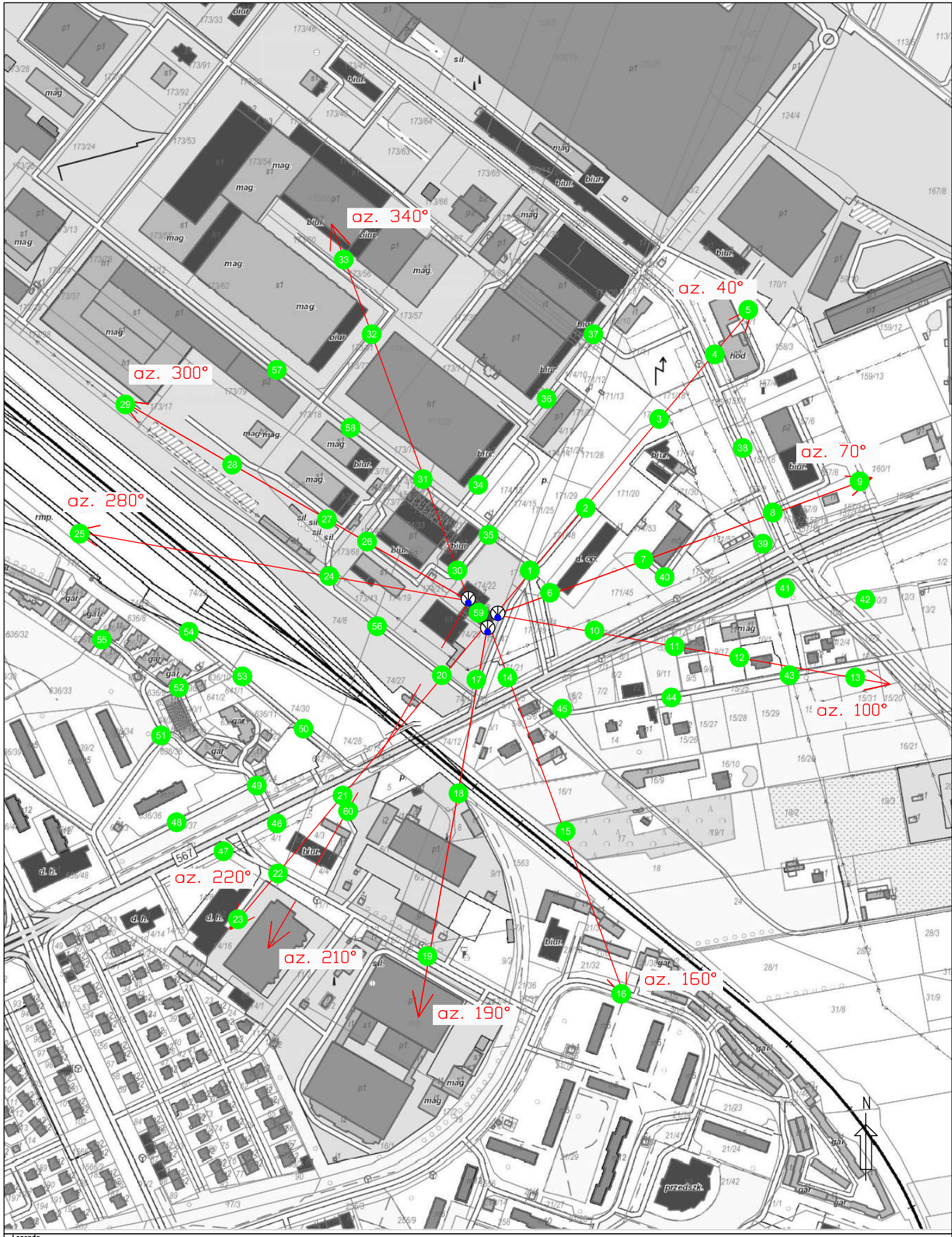
Rys.1 Lokalizacja pionów pomiarowych
